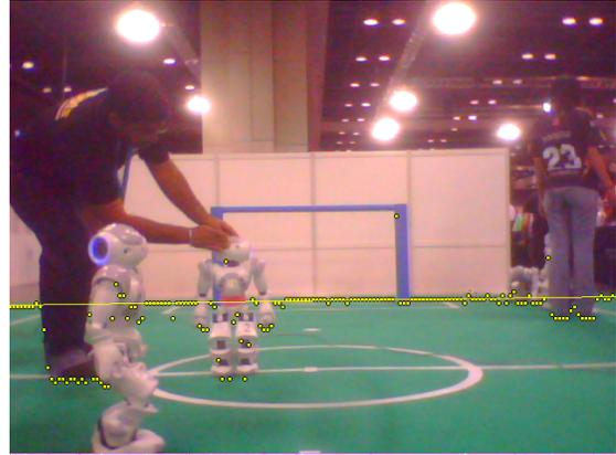
Figure 4: Edge detection using RANSAC.
